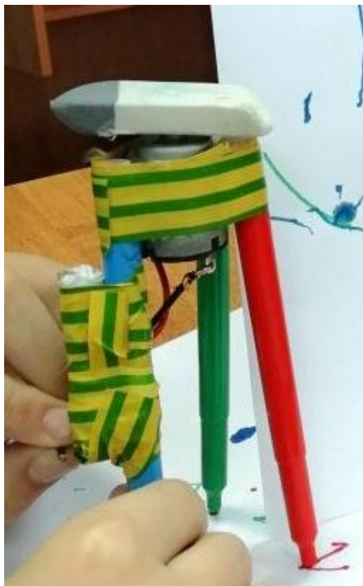
Рис. 10. Робот с тремя ногами, моторчиком, батареей и ластиком среднего размера.
